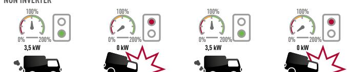
**NON INVERTER.** Lent à démarrer. Il faut plus longtemps pour atteindre la température de consigne. La température oscille entre les deux extrêmes et ne réussit jamais à se stabiliser. La température chute puis augmente brutalement, ce qui engendre un pic de consommation.
